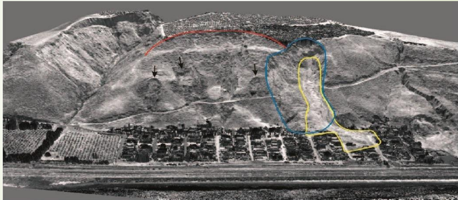
Αναγνώριση διαφορετικών φάσεων κατολίσθησης σε ψηφιακή αναπαράσταση LiDAR (Highland and Bobrowsky, 2008)
