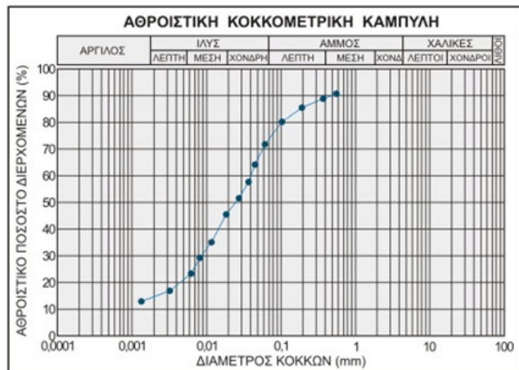
Σχήμα 2.3: Αθροιστική κοκκομετρική καμπύλη εδαφικού σχηματισμού.
