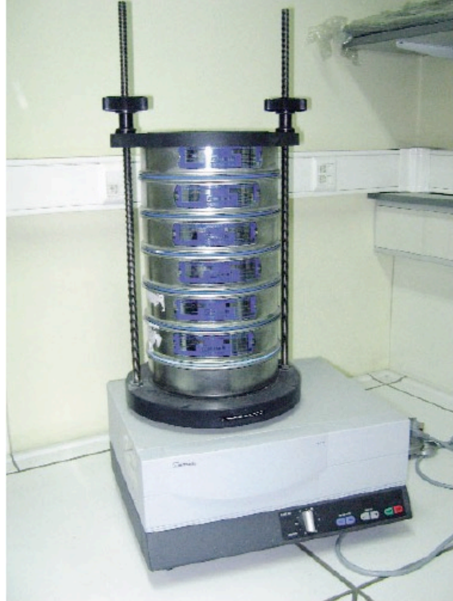
Φωτο 6.1 Σειρά κοσκίνων της εταιρείας Retsch με διαμέτρους 2 mm, 1 mm, 0,5 mm, 0,250 mm, 0,125 mm και 0,063 mm που χρησιμοποιούνται για την κοκκομετρική ανάλυση δειγμάτων άμμου. Τα κόσκινα έχουν τοποθετηθεί κατά σειρά μειούμενης διαμέτρου στη συσκευή δόνησης.
