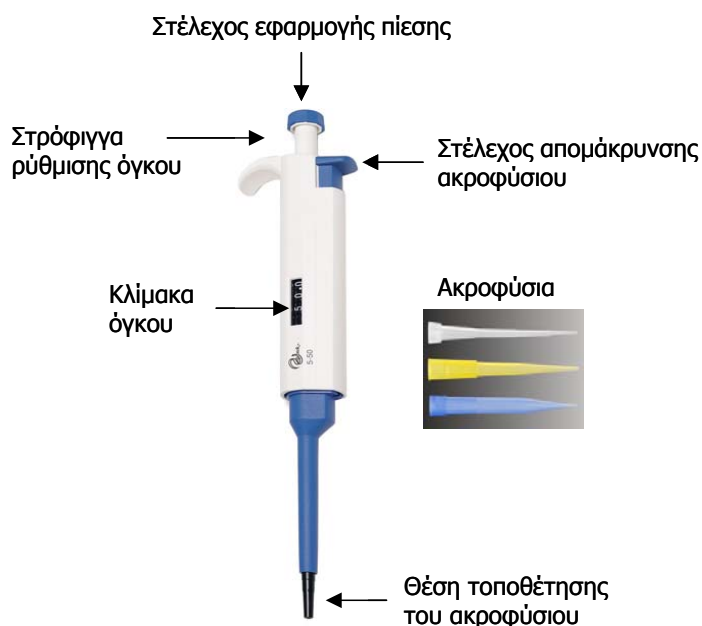
Σχήμα 1. Βασικά σημεία μιας χαρακτηριστικής αυτόματης πιπέτας
