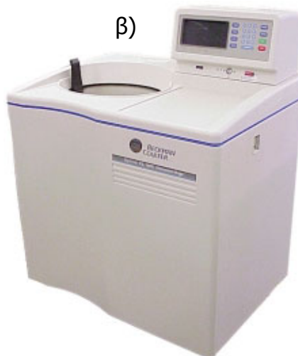
Σχήμα 2.1. Τύποι φυγοκέντρου α) επιτραπέζια φυγόκεντρος β) επιδαπέδια υπερφυγόκεντρος
