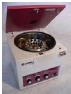
Σχήμα 2.1. Τύποι φυγοκέντρου α) επιτραπέζια φυγόκεντρος β) επιδαπέδια υπερφυγόκεντρος
