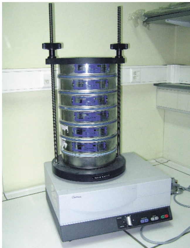
Φωτο 6.1 Σειρά κοσκίνων Retsch με διαμέτρους 2 mm, 1 mm, 0,5 mm, 0,250 mm, 0,125 mm και 0,063 mm που χρησιμοποιούνται για την κοκκομετρική ανάλυση δειγμάτων άμμου. Τα κόσκινα έχουν τοποθετηθεί κατά σειρά μειούμενης διαμέτρου στη συσκευή δόνησης.
