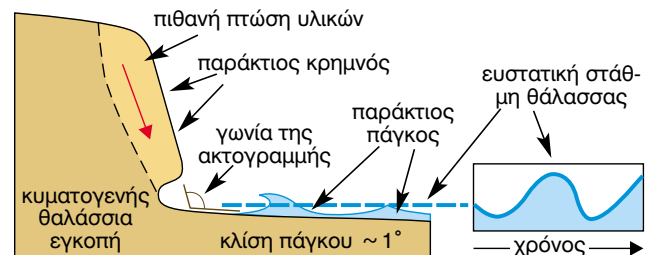
Σχήμα 7.14 Διαβρωσιγενής παράκτιος πάγκος (erosional shore platform), παράκτιος κρημνός (coastal cliff), εγκοπή κυματογενούς προέλευσης (wave cut notch) και η γωνία της ακτογραμμής (shoreline angle). Το άνω όριο του διαβρωσιγενούς παράκτιου πάγκου αλλάζει με την πάροδο του χρόνου και εξαρτάται από τις μεταβολές της στάθμης της θάλασσας.
