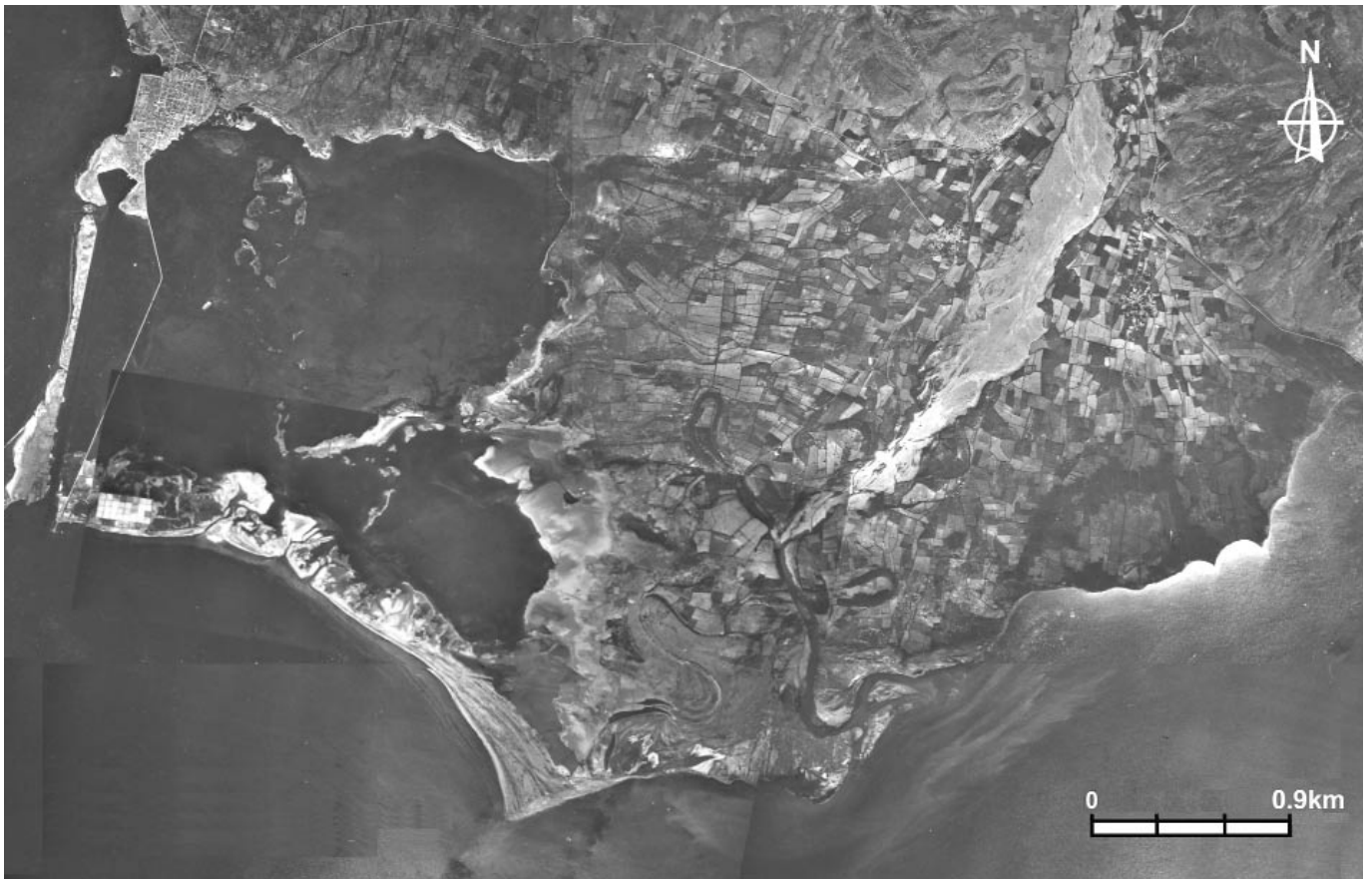
Φωτο 9.3 Αεροφωτομωσαϊκό του δέλτα του Εύηνου ποταμού που έχει προκύψει από τη γεωαναφορά αεροφωτογραφιών της Γεωγραφικής Υπηρεσίας Στρατού (Γ.Υ.Σ.) έτους λήψης 1945. Διακρίνεται η μοναδική ενεργός κοίτη του ποταμού καθώς και τα ίχνη των παλαιών ροών του (εγκαταλελειμμένες κοίτες και αποκομμένοι μαϊάνδροι).
